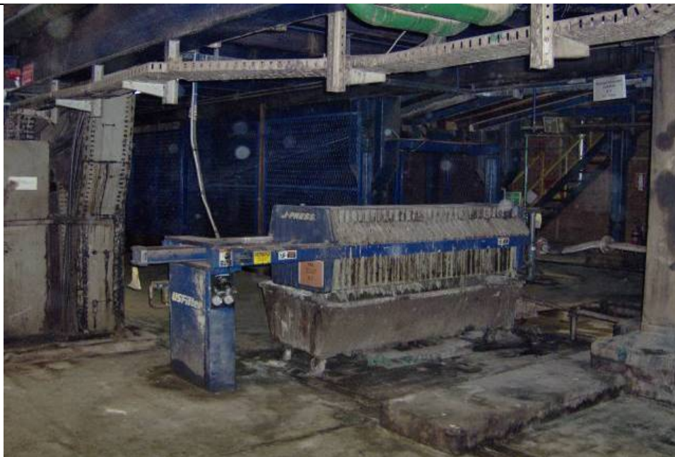
6.6. Filter presa za izdvajanje kalajnog mulja, skladište ETL-1
